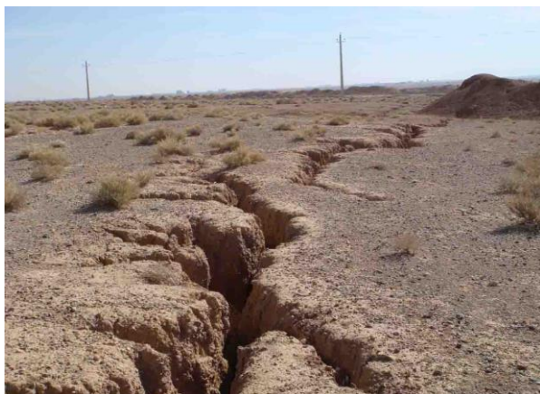
شکل (۹): دو نمونه از ترک و شکاف‌های ناشی از فرونشست زمین در حاشیه ارتفاعات کلاه قاضی سمت دید رو به (جنوب شرق)
