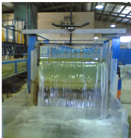
شکل ۳: دریچه کشویی در انتهای فلوم جهت تنظیم عمق و سرعت جریان
