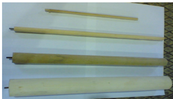
شکل ۴: موانع استوانه ای استفاده شده در تحقیق به قطرهای ۵، ۱۲، ۲۵ و ۴۲ میلیمتر
