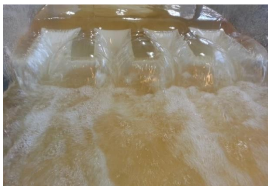
شکل (۷): سرریز کلید پینوئی با زاویه دیواره \alpha=3^\circ و \beta=11^\circ
