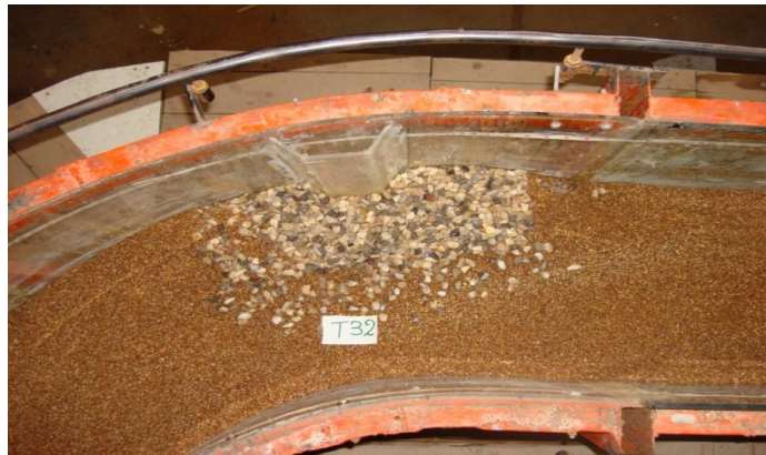
شکل ۳- آستانه شکست سنگ‌چین در نمونه‌ای از آزمایشات
