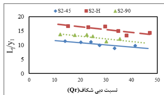
شکل (۲۲): تغییرات نسبت طول پرش به عمق اولیه در برابر درصد دبی شکاف در مدل S ۲
