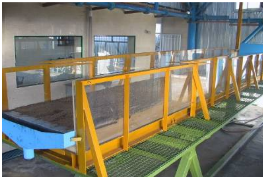
شکل ۴. نمایی از فلوم شیب‌پذیر در سالن آزمایشگاه
